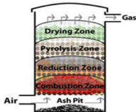
Fig-1: Updraft Gasifier
